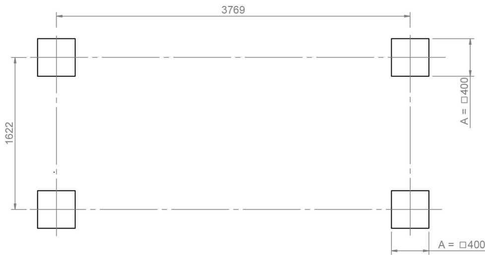
Planta Cimentación Cotas en mm
